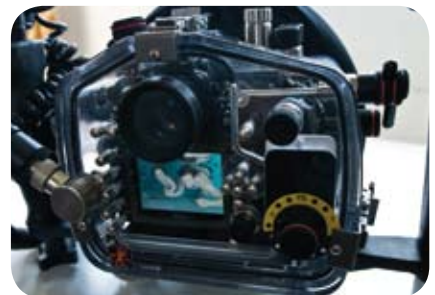
Een spiegelreflexcamera in een onderwaterhuis. Door de grote knoppen is alles nog goed te bedienen, ook met handschoenen aan. Aan het huis zitten een of meer flitsers gekoppeld.
