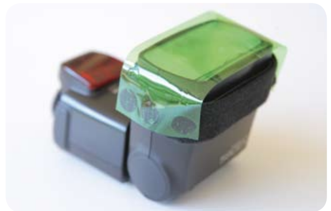
Bevestiging van de gel met klittenband. Door de losse klittenband riem hoef je niks op je flitser vast te plakken.
